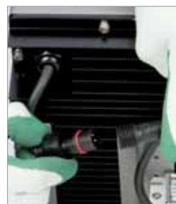
Sistema con connettore ad innesto rapido. System with quick-mount connector.
