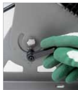
Regolare a piacere tramite la ghiera graduata. Adjust as desired using the graduated ring.
